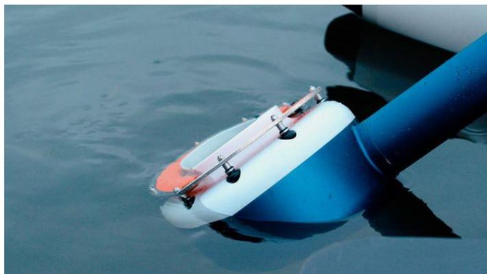
Le Fin 5 est un moteur de 2 kW - équivalent à 5 CV thermiques - dédié aux petites embarcations, annexes et voiliers jusqu'à 3 tonnes. FinX
