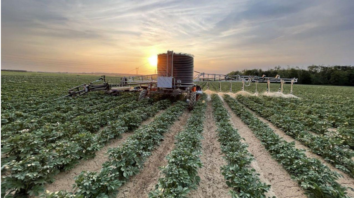
Le robot Oscar tracte une double rampe qui, dépliée sur chaque côté perpendiculairement, irrigue le champ uniformément. (Osiris)
