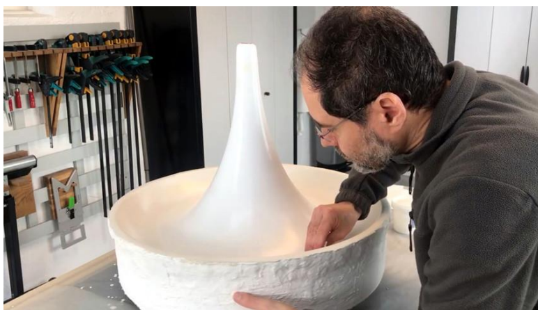
La fabrication d'un pavillon en résine acrylique © LiveHorn
