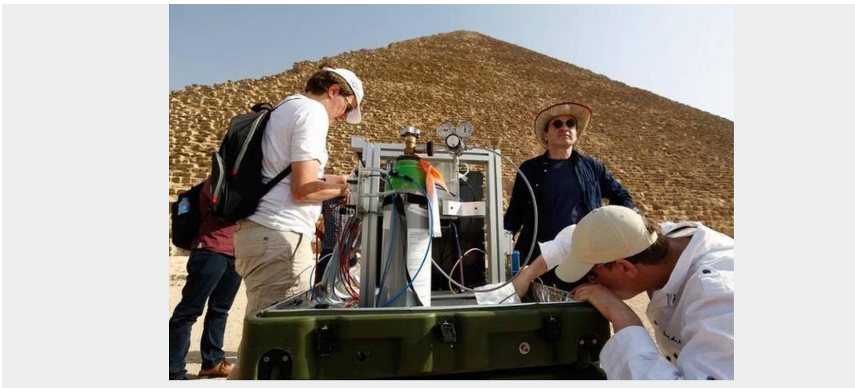
Le CEA a posé pour deux mois deux télescopes d'étude des muons devant les faces Nord et Est de la pyramide de Kheops. (Philippe Bourseiller / HIP Institute)
