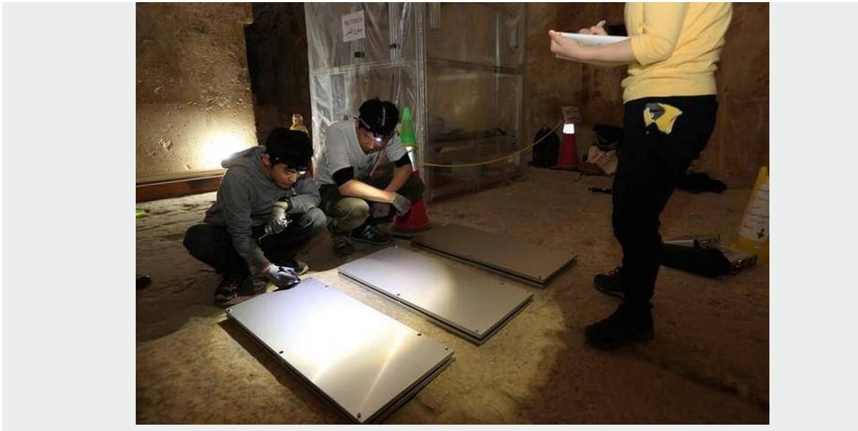
Préparation et mise en place de plaques de muons dans la niche de la chambre de la Reine de la pyramide de Khéops. (Photo : Philippe Bourseiller / HIP Institute)
