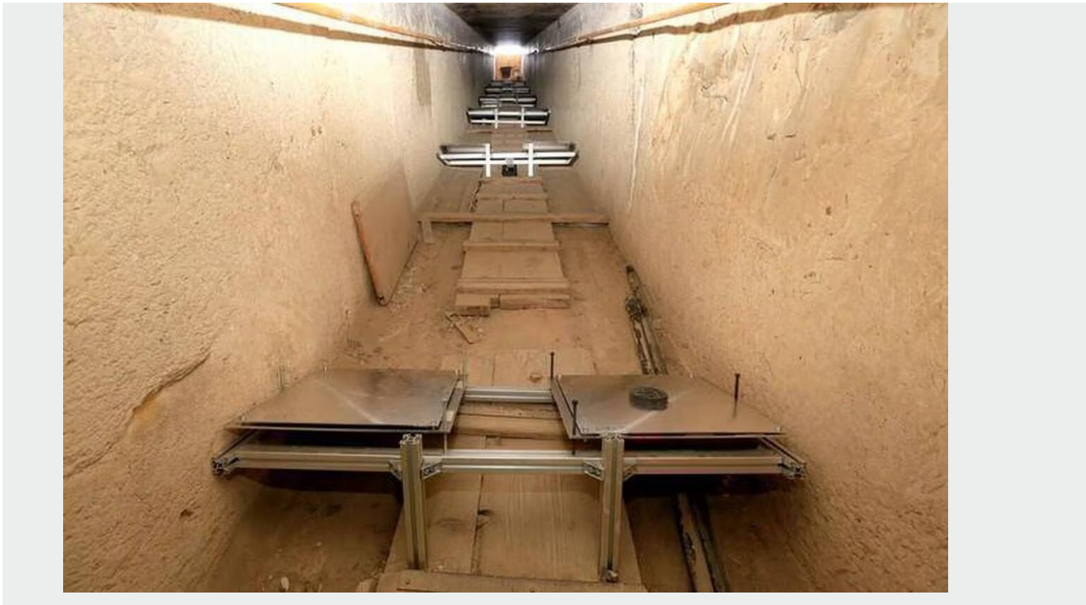
Ces plaques de détections des muons de l'Université de Nagoya installées dans le couloir d'aération supérieur de la pyramide de Kheops sont positionnées sous la zone des chevrons de la face nord. (Philippe Bourseiller / HIP Institute)
