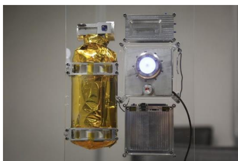
Alimenté en xénon, le moteur d'Exotrail promet de faire des merveilles (droits: Pascal Guittet)
