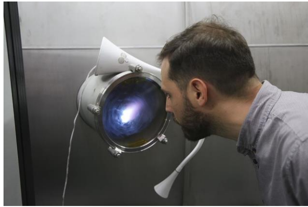
Derrière cet hublot d'une chambre à vide d'Exotrail: une lueur bleuâtre générée par un moteur à xénon (droits: Pascal Guittet)
