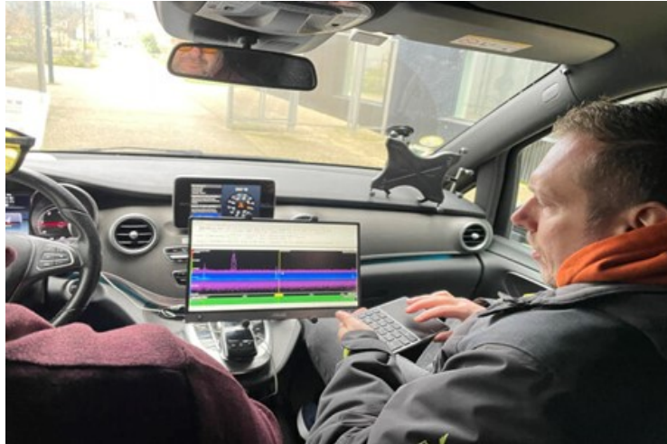
Dans les rues de Nancy, le 23 janvier 2024, les agents auscultent, grâce au radar installé sur le van, l'environnement radioélectrique. ANFR
