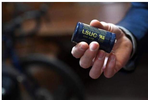
Le supercondensateur est composé d'aluminium et de carbone.
