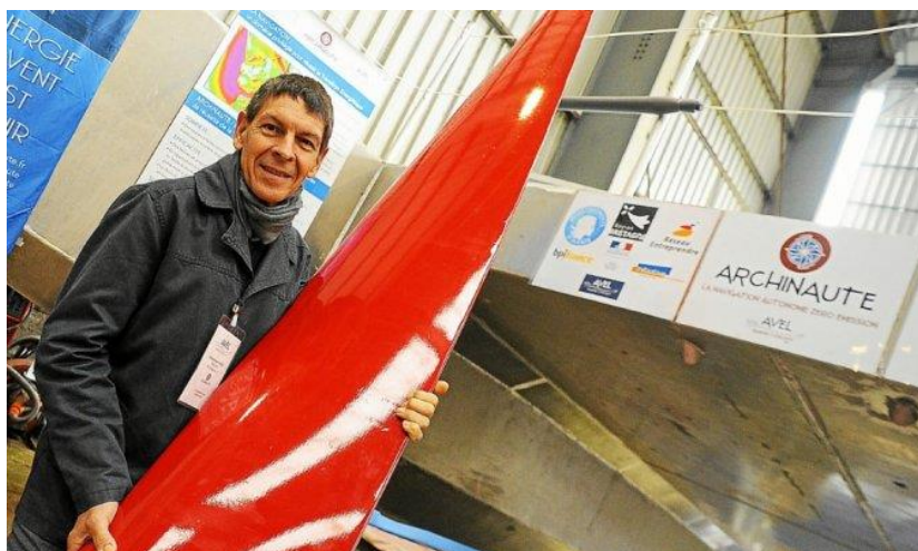
Charles-Henri Viel présente les pales de la voilure tournante qui permettra la propulsion de son prototype technique de 11,40 m, en voie d'achèvement au chantier Bretagne-Sud - Acti.
